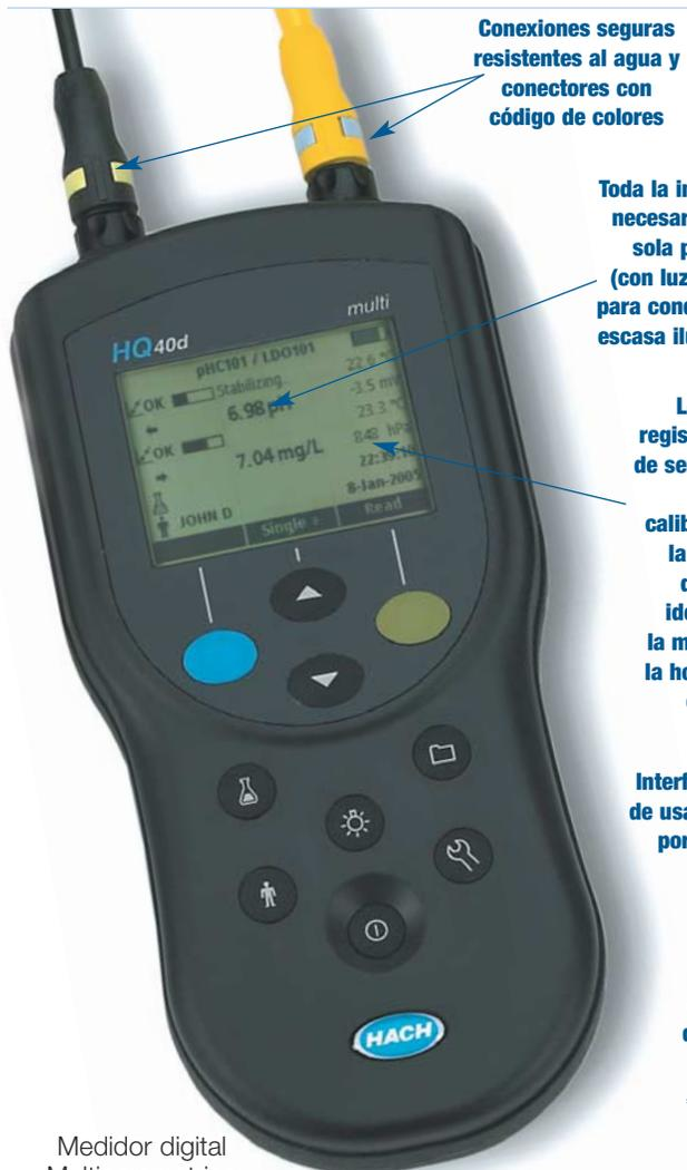
**Conexiones seguras resistentes al agua y conectores con código de colores**
